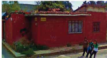
Vivienda con materiales de construcción prefabricados, y losa maciza de concreto. Se empiezan a distinguir aleros con una variación entre 40 y 60 cm y acabados sencillos.
