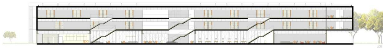
Sección donde se aprecia el funcionamiento del sistema de escaleras del bloque de habitaciones
