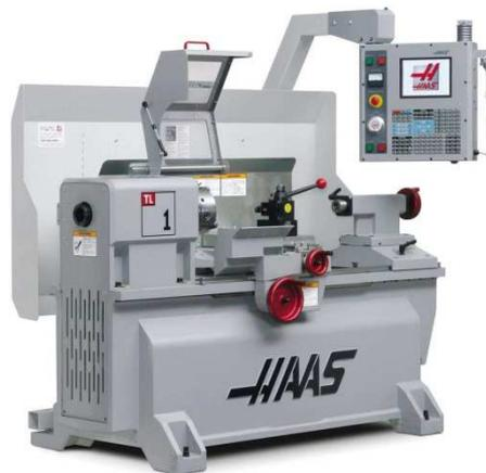
Figura 7: Torno con control numérico
