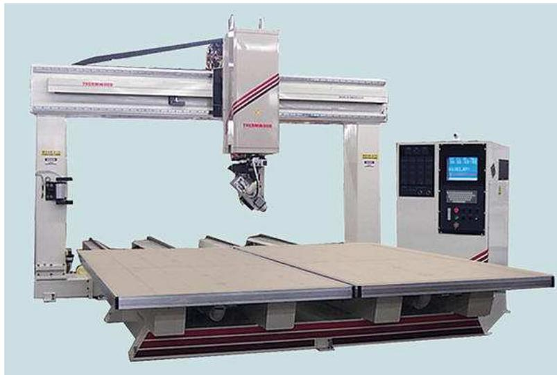
Figura 9: Máquina de control numérico de 5 ejes
