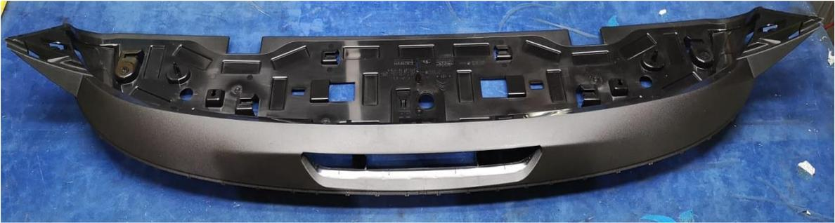
*Ilustración 2 - Inserto sin componentes del alerón*
