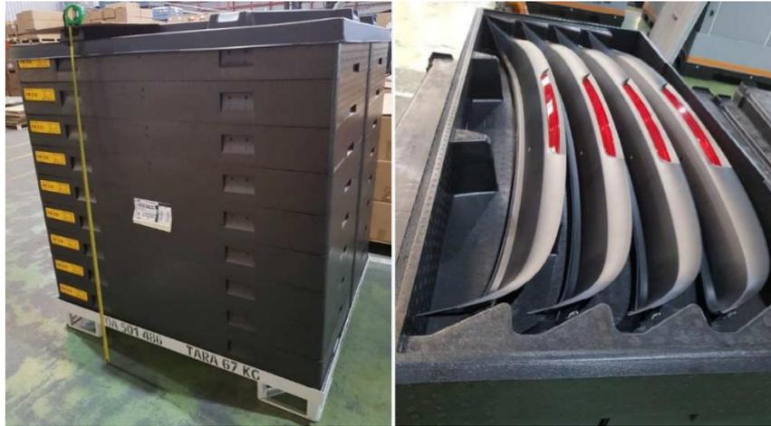
*Ilustración 17 - Embalaje de cliente del blende del VW T-Cross*
