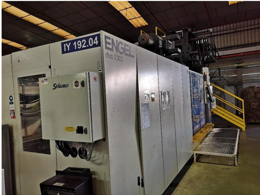
*Ilustración 3 - Inyectora Engel 19204 de 2300 Toneladas*
