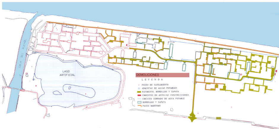
F23. Detalle del plano titulado “Plano de demoliciones”. Proyecto LIFE Duna (2001). Fuente: Archivo del Servicio Municipal Devesa-Albufera .
