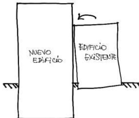
Figura 6. Posible afección por hundimiento de edificios existentes próximos.
