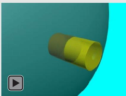
Superficie de un cilindro de eje perpendicular al plano tangente en un punto de la superficie de un conductor sobre la que se aplicará el teorema de Gauss para determinar el campo eléctrico en sus proximidades.
