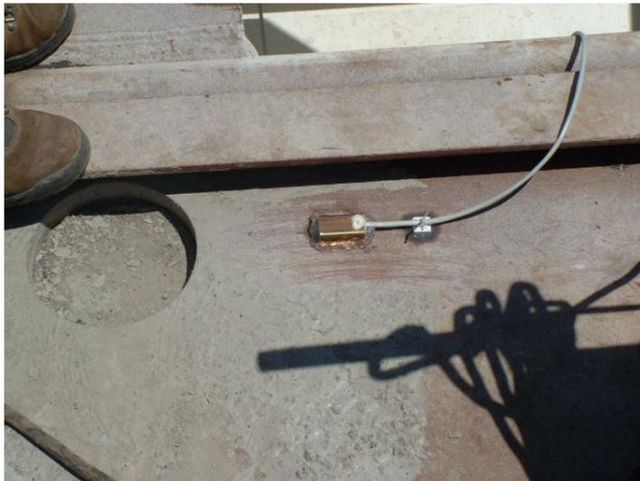
MEDIDOR DE LAS TENSIONES DE LA PLUMA
