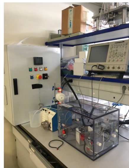
Figura 6 Equipo y cámara empleados para el tratamiento de pulsos eléctricos de alto voltaje.
