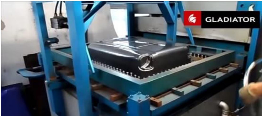
Imagen 51: Conformado del casco de una maleta.
