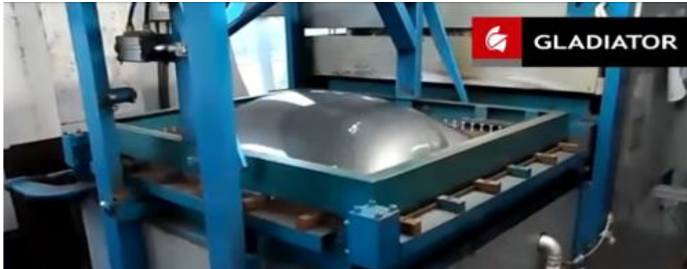
Imagen 50: Conformado del casco de una maleta.
