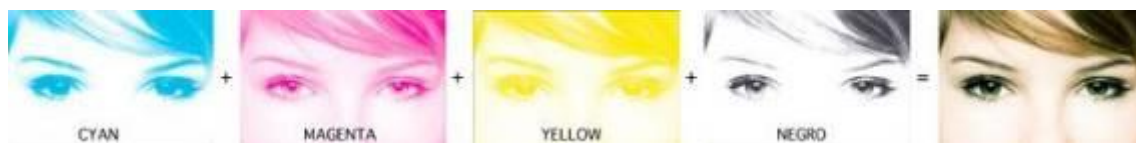
Imagen 48: descomposición del color en el modelo de impresión de cuatricromía
