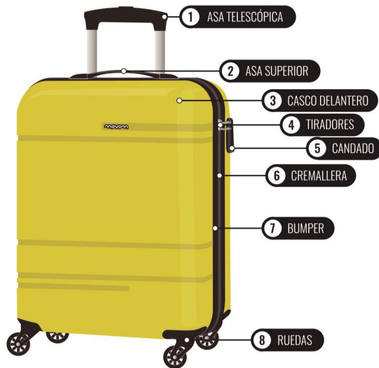
Imagen 18: Elementos básicos de una maleta de cabina convencional
