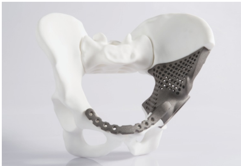
Figura 116: Implante de titanio / Fabricación Aditiva / Tecnología EOS GmbH.
