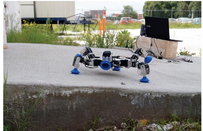
Figura 31: Implementación de la estrategia orientación constante en terreno natural (pendiente de concreto).
