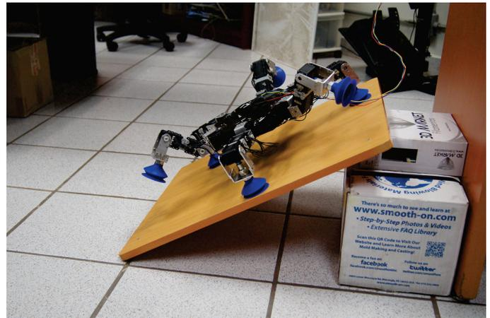
Figura 26: Robot hexápodo posicionado en una superficie inclinada de  $30^\circ$ .
