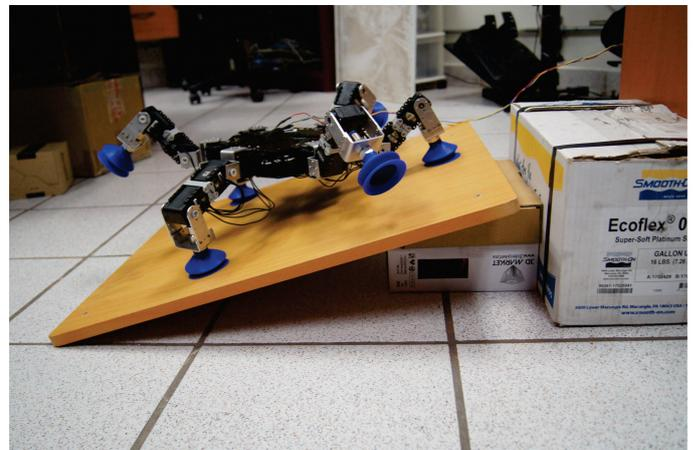
Figura 27: Robot hexápodo reposicionado en una superficie inclinada de  $15^\circ$ , utilizando la estrategia de adaptabilidad orientación constante de forma experimental
