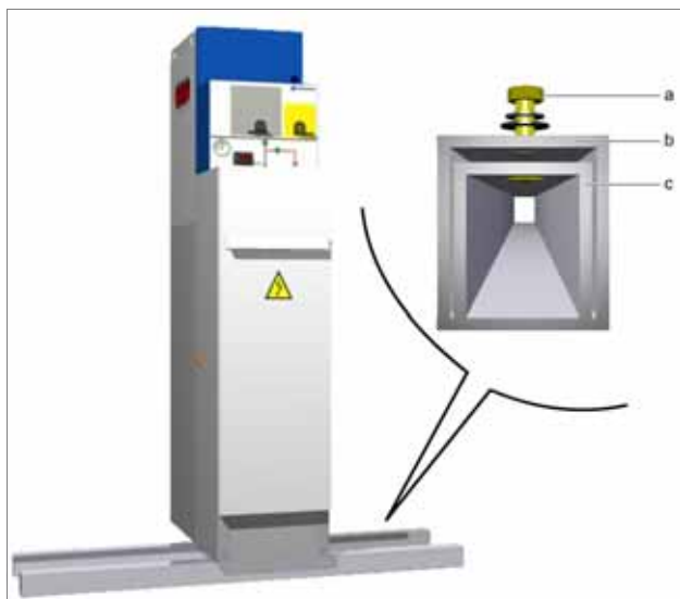
Fig. 4.3: Retirada de tapa inferior
