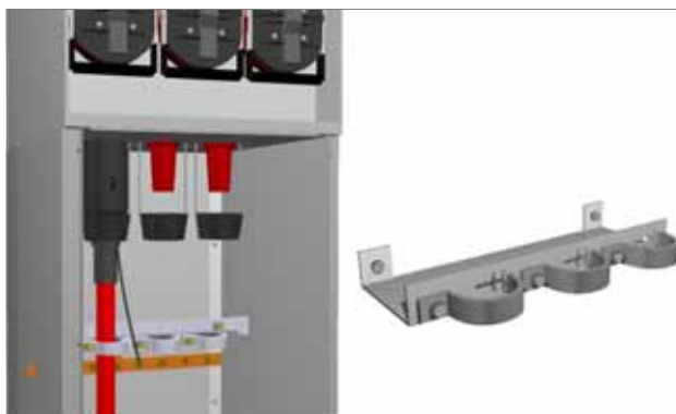
Fig. 4.17: Conexión frontal en funciones de protección de celdas
