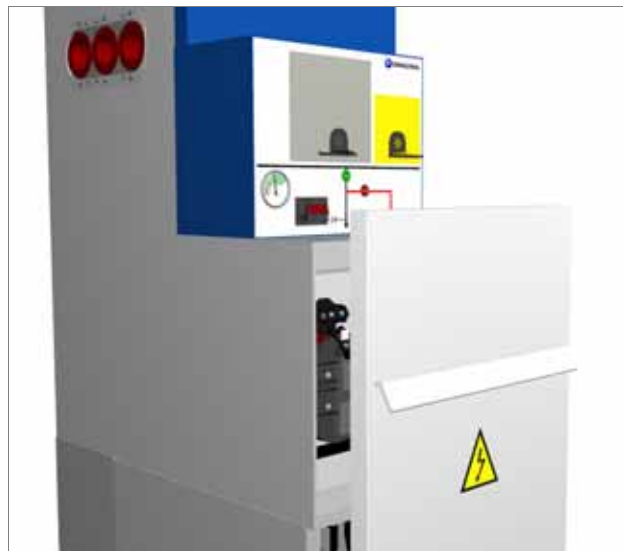
Fig. 4.3: Retirada de tapa inferior
