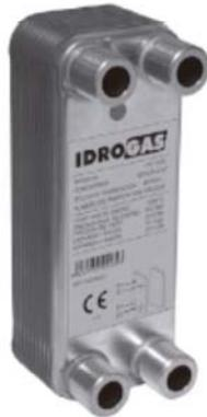
El principio de construcción del intercambiador de placas termosoldado comprende un paquete de placas, está compuesto por placas canal corrugadas entre los paquetes de placas delanteras y traseras de cubierta. Las placas de cubierta constan de placas de sellado, anillos ciegos y placas de cubierta. Durante el proceso de soldadura al vacío se forma una unión soldada en cada punto de contacto entre dos placas. El diseño crea un intercambiador de calor que consta de dos circuitos separados.
