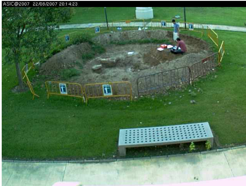
Figura 13. Foto de ensayo in situ en la Universidad Politécnica de Valencia con un terreno arcilloso procedente de una excavación antecedente. Se encontró un valor de la \epsilon = 8 . Se utilizó la antena de 400 MHz, y la tubería de 110 mm se puso a una profundidad de 50 cm
