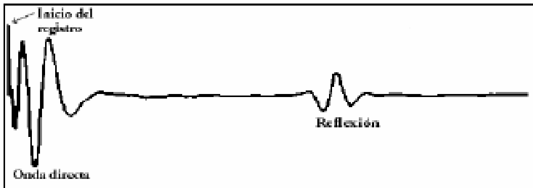
Figura 4. Ejemplo de traza de amplitud: reflexiones de energía en función del tiempo
