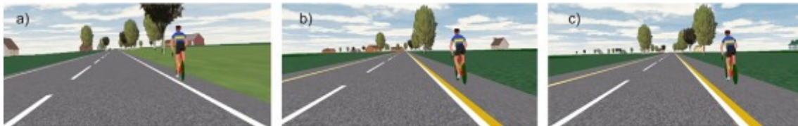
Fig. 5.21 - Ciclista en las configuraciones de sección transversal propuestas por Silvestri (2017): a) carril del vehículo de 3,50 m y sin carril bici, b) carril bici de 1,50 m y carril del vehículo de 3,00 m, y c) carril bici de 1,75 m y carril del vehículo de 2,75 m
