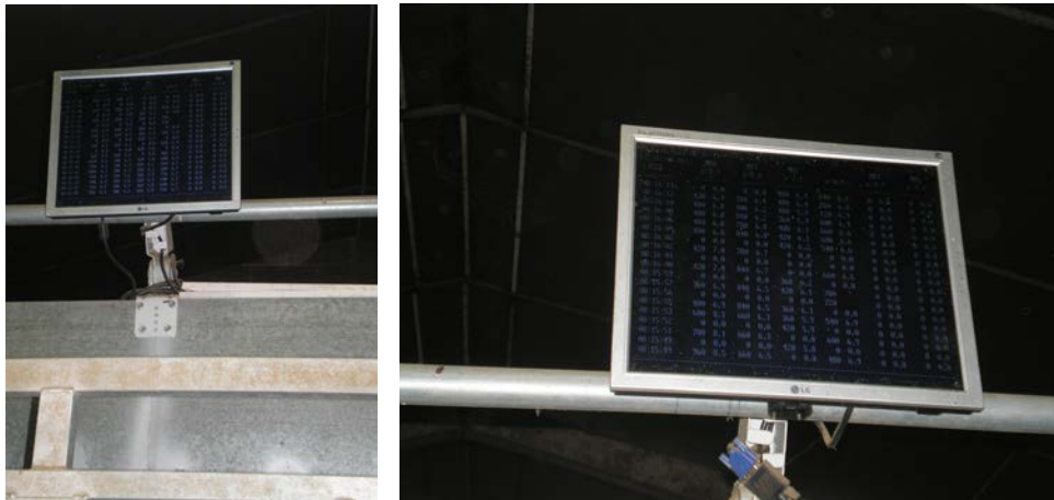
Figura 12. Pantallas mostrando los datos enviados por el ordenador procedentes del medidor electrónico
