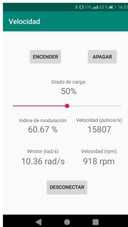
Figura 77. Pantalla de control del motor
