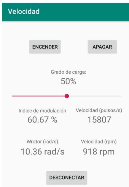
Se puede observar que al aumentar el grado de carga aumenta ligeramente la velocidad y al aumentar esta aumenta también el índice de modulación, además de la velocidad de deslizamiento del rotor.
