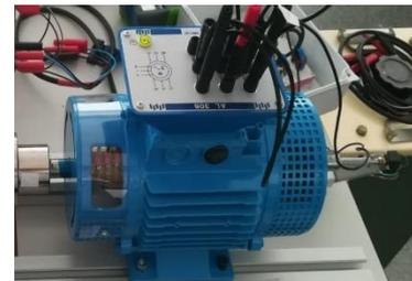
Figura 9. Motor trifásico
