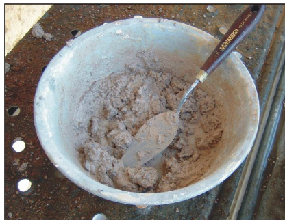
Fig.26 Mortero para las juntas de los ladrillos.
