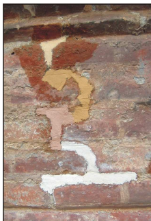
Fig.25 Pruebas para la obtención del color del mortero.
