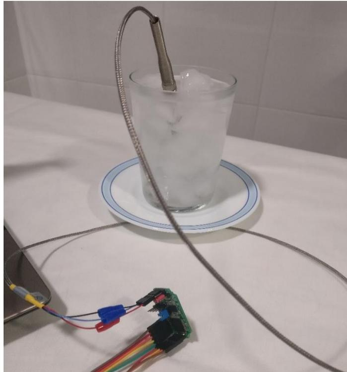
Figura 22: Ensayo con agua a 0°C de la Pt100 de 3 hilos
