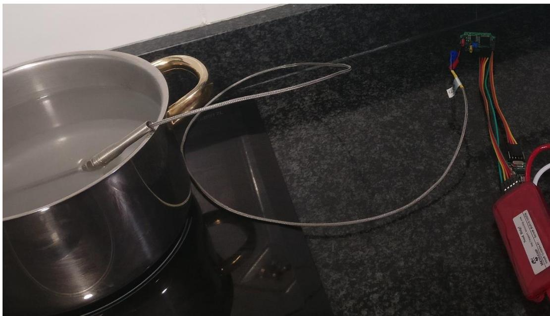
Figura 23: Preparación del ensayo de la Pt100 de 4 hilos con agua a 100°C
