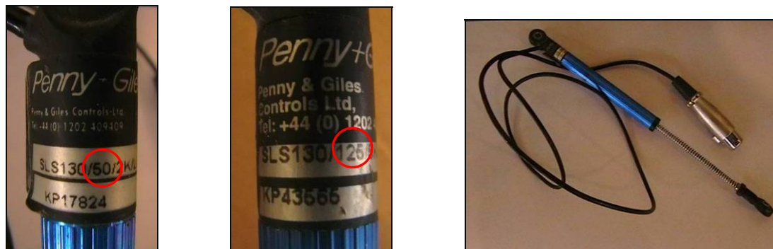
Figura 3.19. Captadores de desplazamientos para medir deslizamiento de bloques y aberturas de fisura. (Captador de 50mm para aberturas y de 125mm para deslizamientos).
