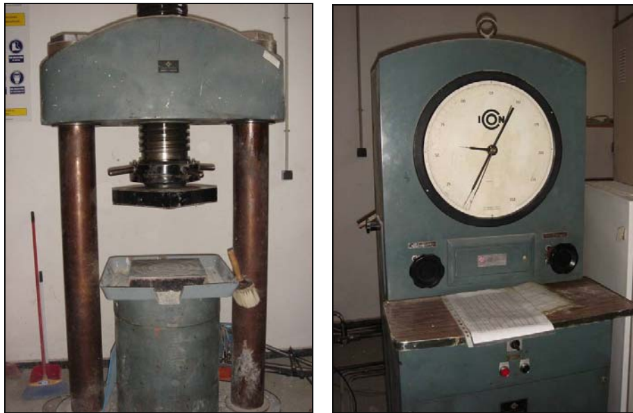
Figura 3.17. Prensa ICON para medición de resistencia a compresión de las probetas y determinación de módulos de deformación.
