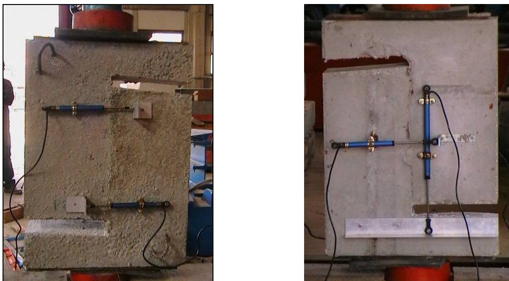
Figura 3.20. Colocación de los captadores de desplazamiento en las probetas
