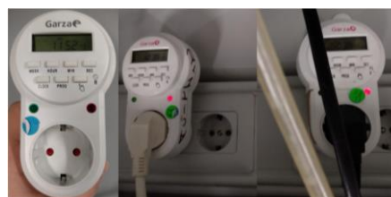
Figura 47. Timers de Garza, para los equipos adyacentes a los SBR.
