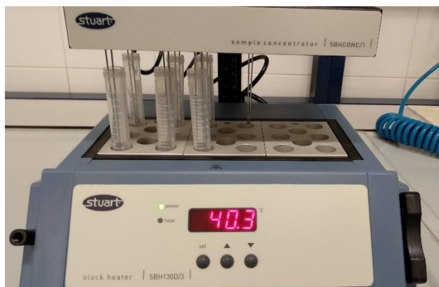
Figura 29. Concentrador de muestras (Sample Concentrator, SBHCONC/1) y calentador (Block Heater, SBH130D/3) de STUART con 6 muestras con fármaco.
