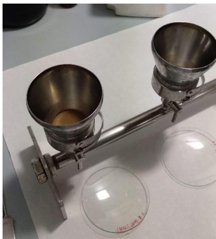
Figura 21. Muestra para medir sólidos en suspensión con la torta en el filtro.
