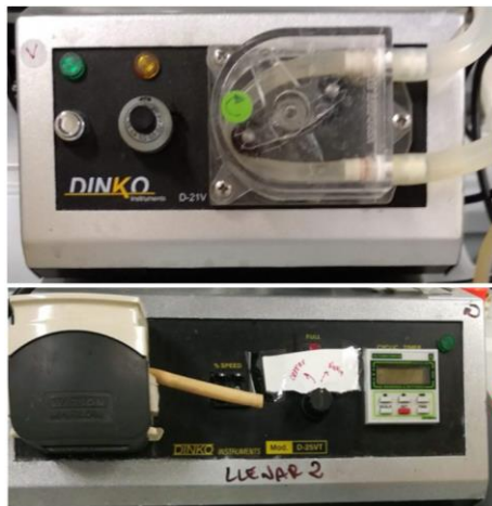
Figura 46. Bombas de vaciado de los SBR de DINKO Instruments.
