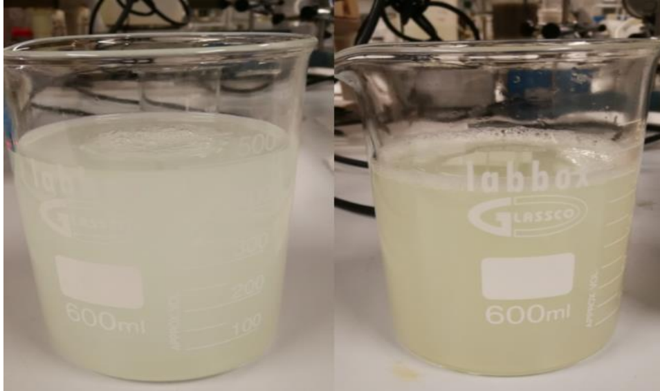
Figura 25. Muestra de detergente de concentración 2% tratado a 20°C durante 20 minutos.
