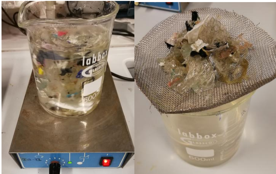
Figura 14. Etapa de agitación y filtración posterior del agua residual.
