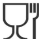
Figura 4. Símbolo que refleja que el envase es apto para interaccionar con alimentos [9].
