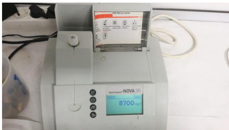
Figura 12. Fotómetro para la medición de DQO.
