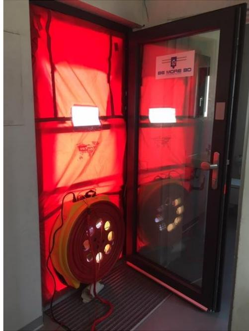
Figura 16. Fotografía de la puerta de la vivienda durante el Blower Door Test. Elaboración propia.
