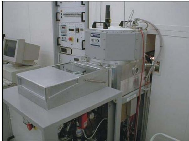
Fig. 4.4. Detalle del dispositivo encargado del ataque inductivo de plasma ICP.
