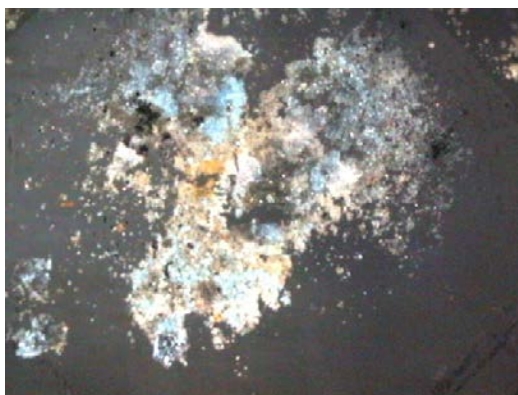
200x detalle del raspado superior de la muestra bajo estudio. Obsérvense los pigmentos amarillos.
