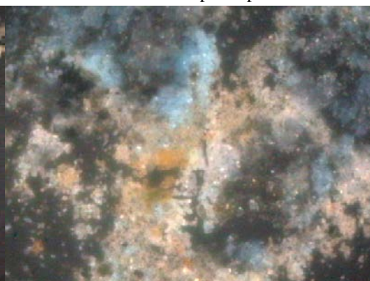
400x, detalle de los pigmentos amarillos pertenecientes al raspado de la muestra en superficie sobre la capa n°4.
