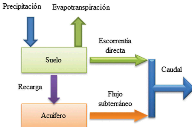
Figura 2. Esquema conceptual del ciclo hidrológico en el modelo abcd de Thomas.
