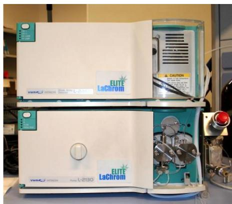
**Figura 7.5.** Sistema de HPLC Hitachi Lachrom-Elite equipado con columna Lichrospher 100 RP-18 (5  $\mu\text{m}$ ) y sistema de detección Diodo Array L-2450 empleado para las medidas cromatográficas.
