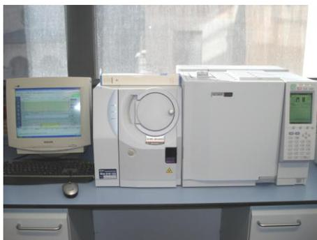
**Figura 7.9** Cromatógrafo de gases con espectroscopía de masas empleado.
