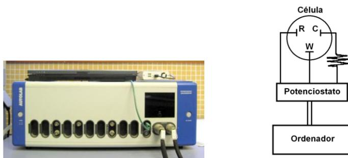
**Figura 7.11.** (a) Potenciostato/Galvanostato PGSTAT302 empleado para las medidas de voltametría cíclica. (b) Esquema general de la disposición de equipos y célula en las experiencias voltamétricas.
