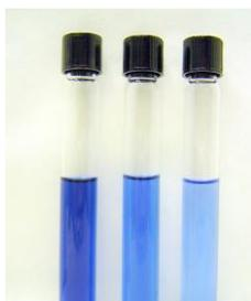
**Figura 8.60.** De izquierda a derecha: muestra final tras la reducción del C.I. Reactive Black 5 tras una dilución 1:10, 1:20 y 1:40.
