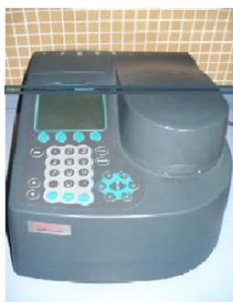
**Figura 7.8.** Espectrofotómetro Uv-Visible Genesys-10.
