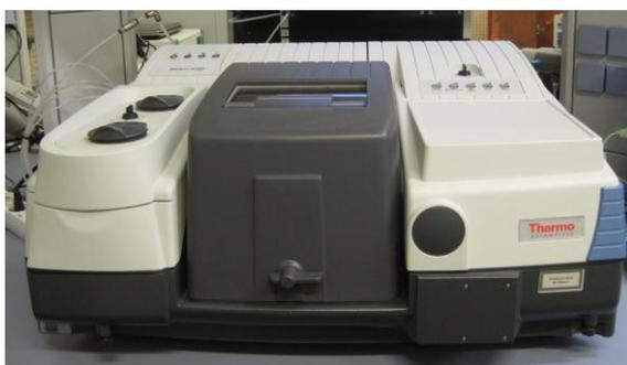
**Figura 7.2.** Espectrómetro FTIR Nicolet 6700 con detector DTGS.
