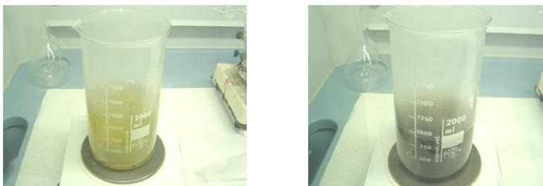
**Figura 7.17.** Oscurecimiento observado en la disolución de ácido oxálico (10%) tras hervir durante un hora con el sustrato de Ti.
