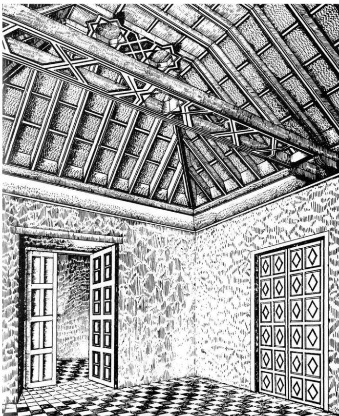
Alfarje de par y nudillo con harneruelo y tirantes pareados_ Aposento de la Casa de la calle Obispo 117-119 Fuente: Prat Puig, F.
