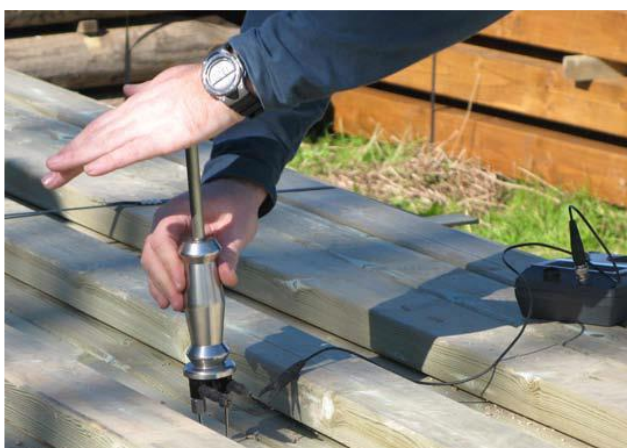
Ensayo mediante el uso de xilohigrómetro Fuente: Monfort Lleonart, J. (Estructuras de madera. UPV, 2017).
