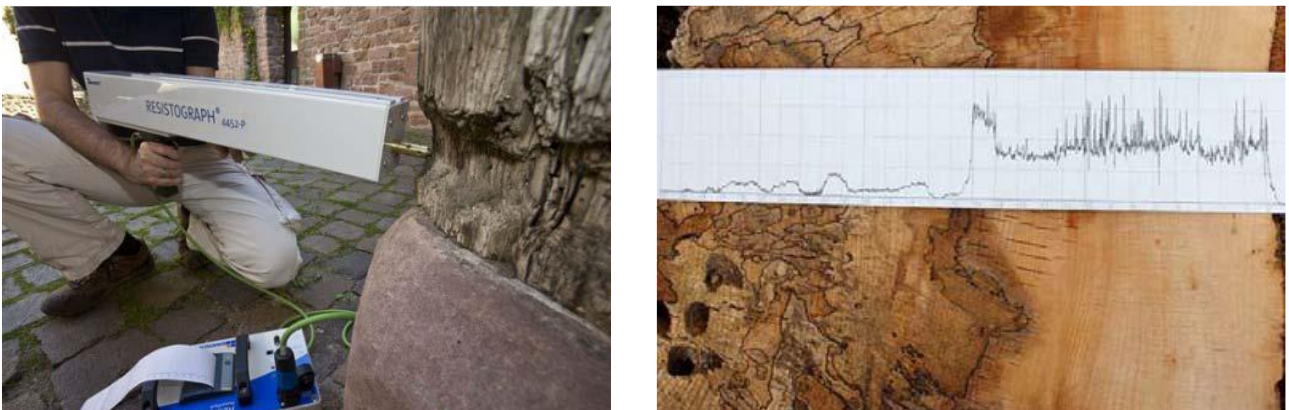
Ensayo mediante el uso de resistógrafo (izquierda) y resistograma (derecha)
