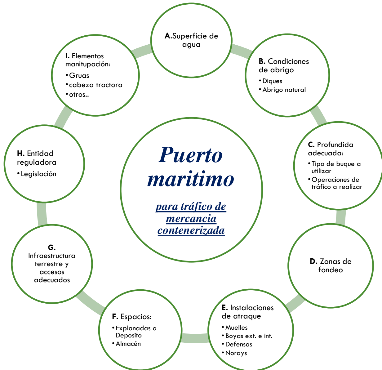
Esquema XI: Componentes fundamentales de un Puerto Marítimo especializado en tráfico de mercancía contenerizada, Fuente: Elaboración propia
