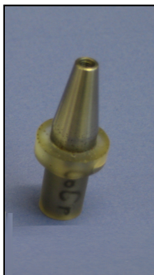
Figura 4.2. Probeta del material protésico (Co-Cr-Mo con alto contenido en C).
