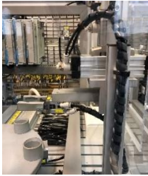
Ilustración 31. (Actuadores: C+, D+ y E+; Sensores: c0, c1, d0 y e1) Extracción de botes
