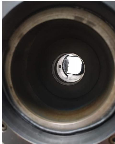
*Figura 35. Pistón transparente con el espejo al fondo.*
