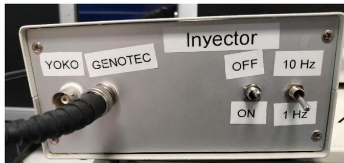
*Figura 47. Generador de pulsos.*
