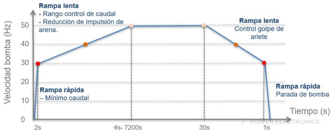
Figura 15. Rampas de aceleración y parada configuradas en el variador. Fuente: bombeo solar de Power Electronics.
