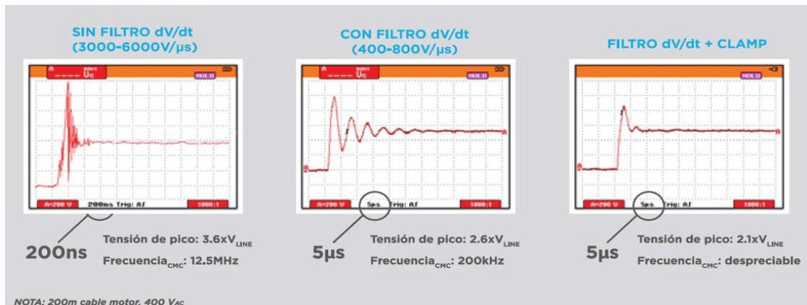
Figura 17. Picos de tensión para una longitud de 200 m y 400 V. Fuente: bombeo solar de Power Electronics.
