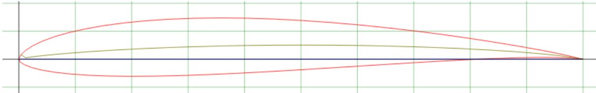
Figura 3.5. Perfil Eppler 222. Extradido de [airfoiltools.org](http://airfoiltools.org)
