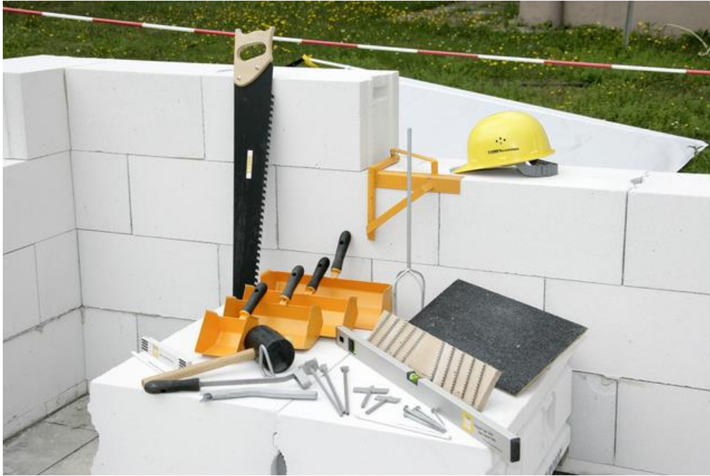
Figura 33. Herramientas empleadas para colocación de bloques de hormigón celular. Fuente: YTONG ( https://www.ytong.es/herramientas_1488.php ).
