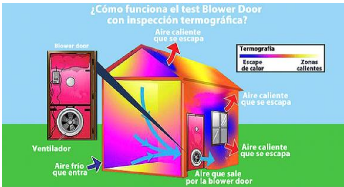
Figura 14. Funcionamiento del ensayo de Blower Door. Fuente: Jesfer ( https://jesfer.com/casas-pasivas/5-principios-basicos-de-un-diseno-passivhaus/ ).
