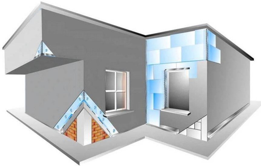
Figura 67. Detalle del revestimiento de mortero sobre las placas de aislamiento formando la capa base. Fuente: ChovA, Impermeabilización y aislamiento - SATE https://chova.com/sistemas/aislamiento-termico-xps/aislamiento-paredes/sate/ .
