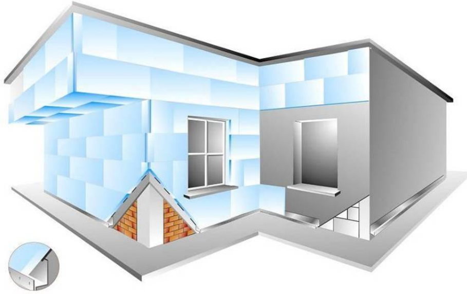
Figura 66. Detalle de la colocación del aislamiento térmico EPS sobre la fachada. Fuente: ChovA, Impermeabilización y aislamiento - SATE https://chova.com/sistemas/aislamiento-termico-xps/aislamiento-paredes/sate/ .
