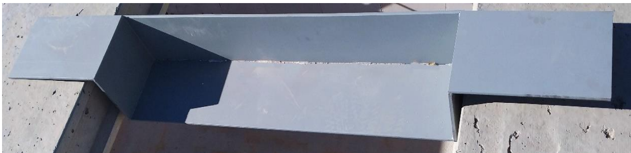
Figura 41. Chapa metálica diseñada para el apoyo de placas alveolares en forjado. Fuente: elaboración propia.
