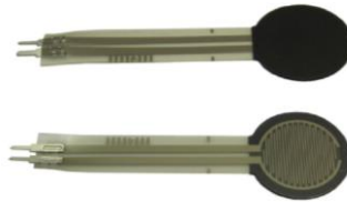
Figura 58. Sensor de fuerza resistivo empleado
