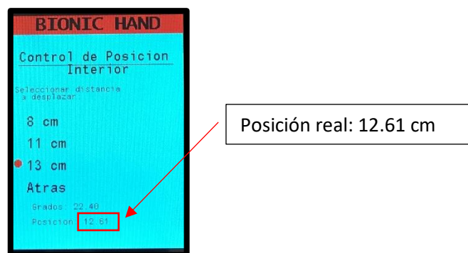
Figura 98. Representación de la posición real sobre la interfaz
