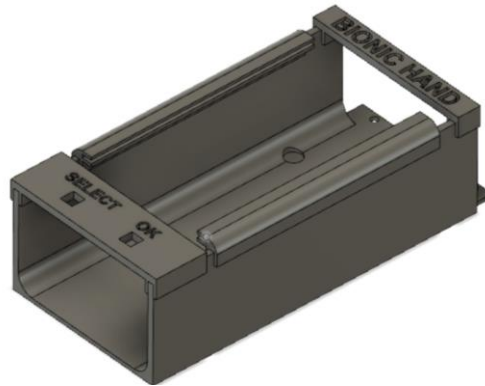
Figura 40. Ensamblado de las piezas que componen Caja Electrónica
