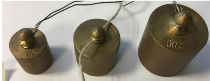
Figura 62. Diferentes pesos empleados en la calibración del sensor
