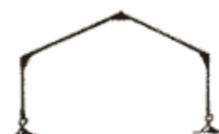
Sin embargo, presenta una desventaja y es que, al hacer la unión de este tipo, es necesario aumentar las secciones de los dinteles y cartelas para resistir las flexiones producidas.
