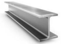
En cuanto a la disposición del perfil, el eje de mayor inercia del perfil IPE (eje local y-y) debe ser perpendicular al plano que contiene la mayor longitud de pandeo.
