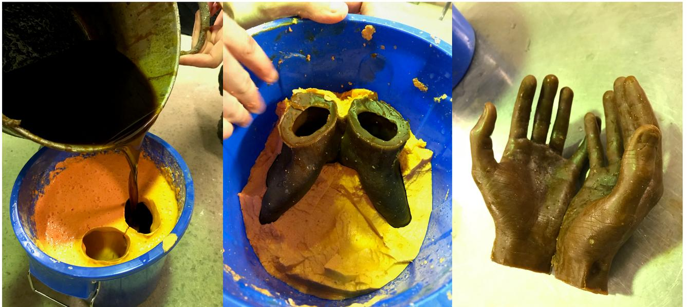
**Fig. 55.** Vertido de cera, extracción del modelo en cera.
