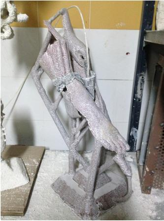
**Fig. 23.** Pieza con 1er baño.
