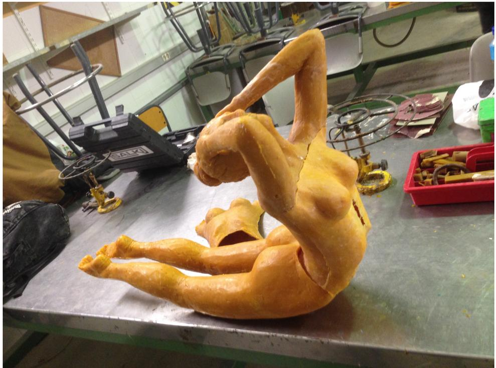
**Fig. 37.** Encaje del modelo en cera.
