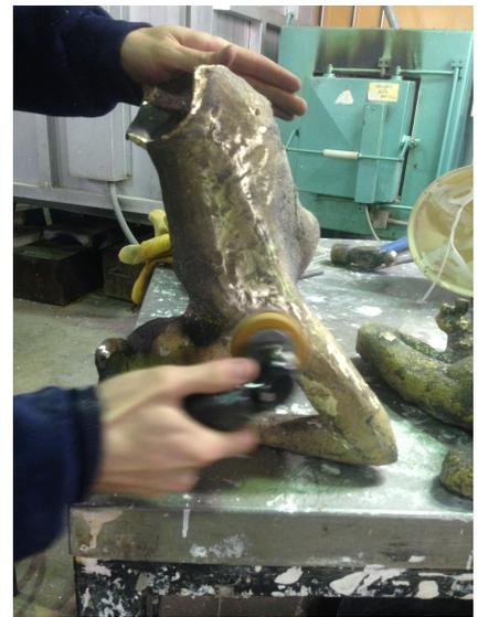
**Fig. 39.** Lijado superficial del metal.
