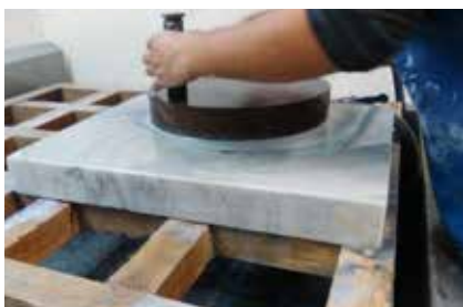
Figura 87 Procés de granejant de la pedra de marbre
