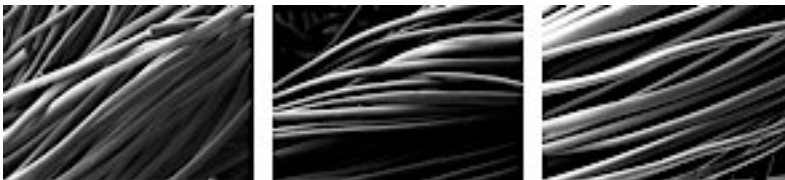
Figura 4.55: Imágenes FESEM (x200) de los catalizadores 1%, 0.5% y 0,25%Pd/ACF(red) a aumentos similares
