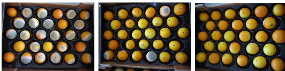
Figura 5.56: Imágenes de las naranjas tratadas, de izquierda a derecha: control (sin tratamiento), tratadas con 4%_LTA-1_100% y tratadas con 4%_FAU-2,4_100%
