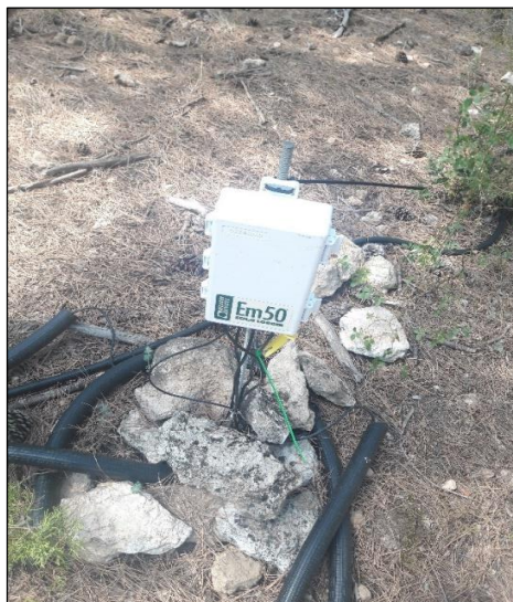
Figura 13. Colocación del Data Logger.
