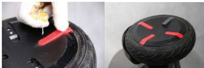
Figuras (6.12): Colocación de tapas en las cubiertas de las ruedas
