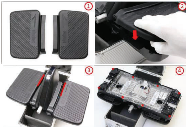
Figuras (6.9): Instalación de los pedales a la base del vehículo
