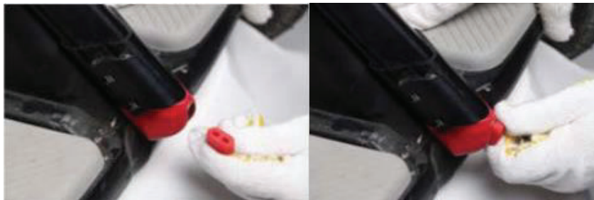
Figuras (6.24): Instalación de la cubierta de la dirección
