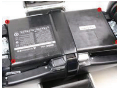
Figura (6.20): Colocación de la batería en el vehículo
