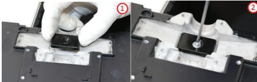
Figuras (6.1): Instalación de un tapón elástico
