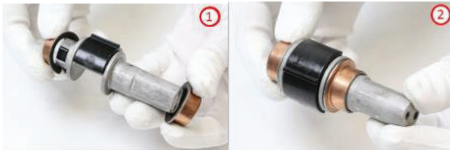
Figuras (6.3): Enroscado del cojinete en el eje
