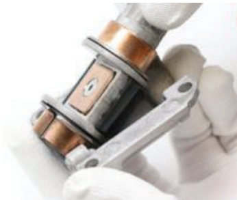
Figura (6.4): Colocación del eje en la cámara de sujeción
