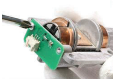
Figura (6.5): Instalación del sensor Hall en la cámara de sujeción
