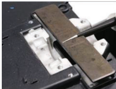
Figura (6.2): Instalación de una placa de acero de resorte
