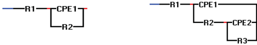
Figura 50. Modelos eléctricos empleados en el ajuste de los espectros para titanio en condiciones de pH2.
