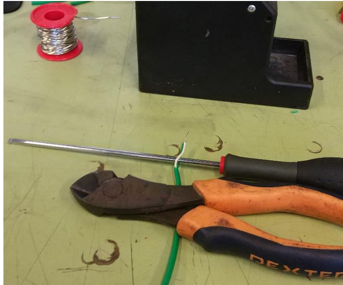
Ilustración 6: Soldadura de la unión termopar tipo K.
