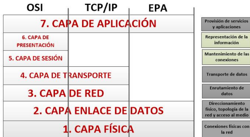
Figura 5.2.2. Pilas de comunicación OSI, TCP/IP y EPA
