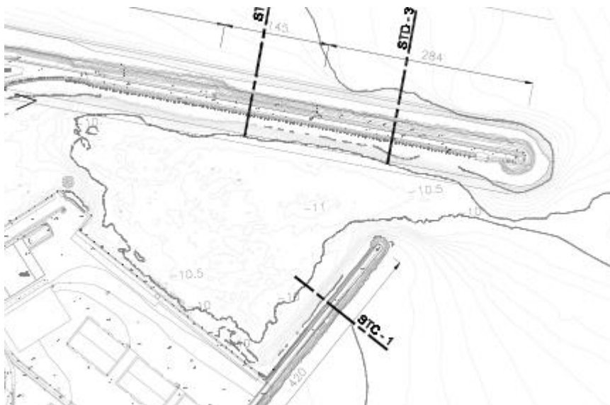
Figura 2. Batimetría de la dársena comercial. (Fuente: APV).
