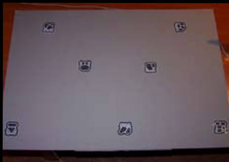
LA DISPOSICIÓN DE LAS MARCAS SOBRE LA MESA DEBE IMPEDIR QUE SOLO UNA MANO TAPE MÁS DE UNA MARCA A LA VEZ
