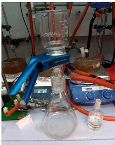
Figura 7. Equipo de filtro a vacío para recuperar el catalizador
