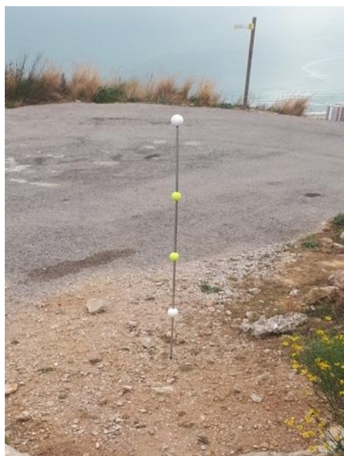
Figura 6– Puntos de apoyo Fuente: elaboración propia
